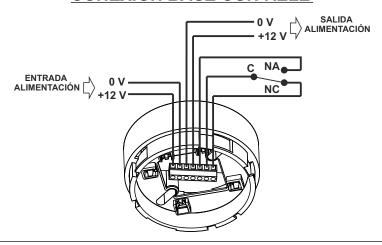
Con el fin de evitar la extracción de los detectores, estos podrán se bloqueados recortando el extremo de la lengüeta situada al lateral de la base. Para poder retirarlos bastará introducir el extremo de
