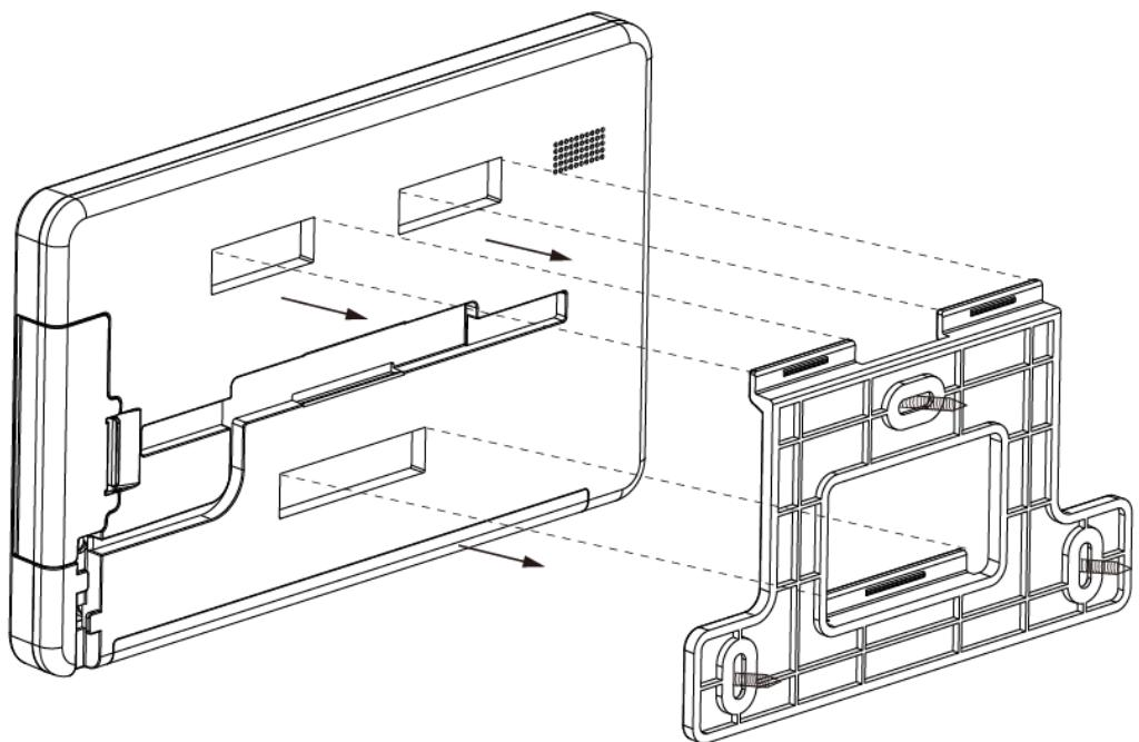
**Paso 5.**Sostenga el teclado de la pantalla táctil y presione suavemente hacia abajo hasta que escuche un sonido de "clic".
